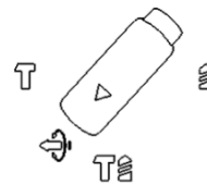
Ajuste del ángulo del cincel plano
